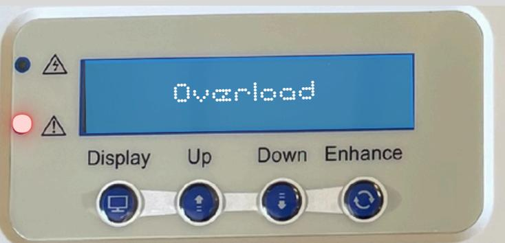
Lorsque la LED rouge reste fixe avec un message "Overload", cela signifie que le routeur est en surcharge. Vérifiez la puissance des appareils connectés. Si cela persiste, contactez-nous via : **sav@solu-sun.fr**
